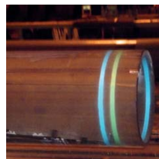
Farbringmarkierung auf Stahlrohren
