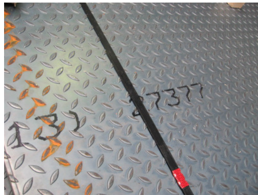
Abb.1: REA-JET Großschrift-Kennzeichnung von Tränenblechen
