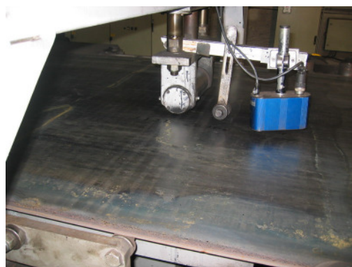
Abb.3: REA-JET Tintenstrahl DOD Schreibkopf an der Produktionsstraße
