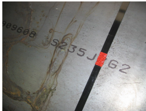
Abb.2: REA-JET Beschriftung von Stahlblechen mit verölter Oberfläche
