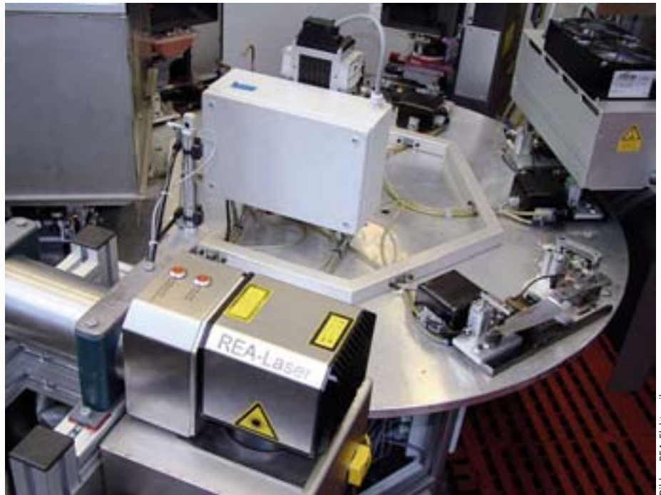
Bild 2: Rundtaktisch mit dem REA-Jet-FL-Faserlaser und einem Messer, das bereits graviert und mit einem zweifarbigen Tampondruck versehen ist.
