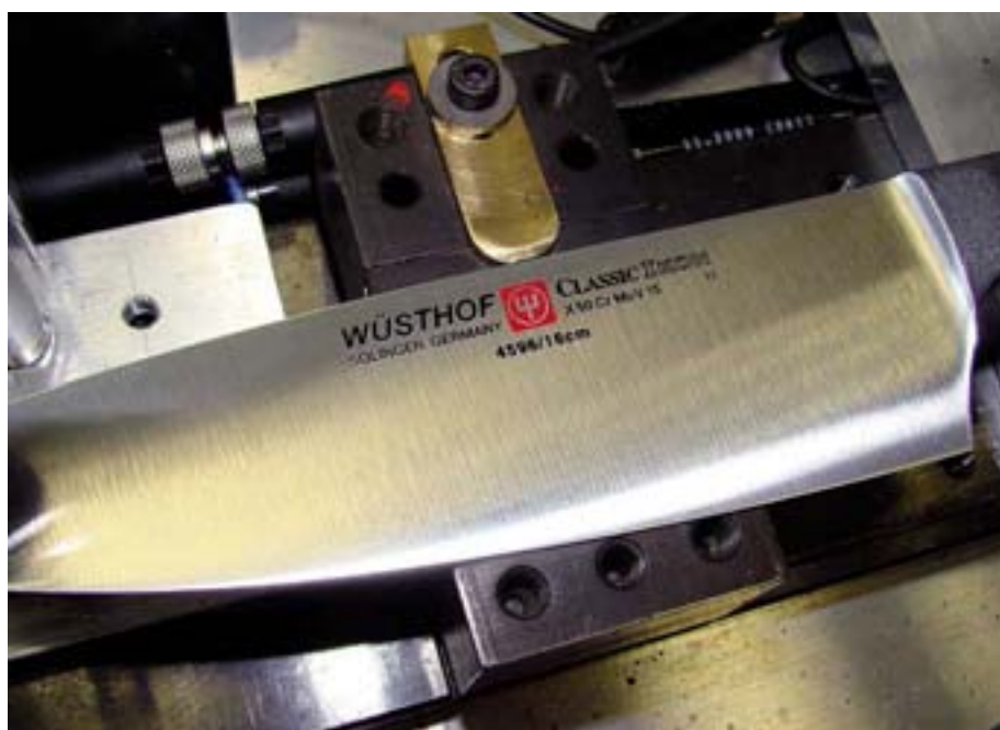
Bild 1: Das Messer im Rohzustand nach dem Lasern und dem Tampondruck – das Logo in Rot, Artikelnummer, Zusammensetzung des Stahls und Klinglänge in Schwarz.
