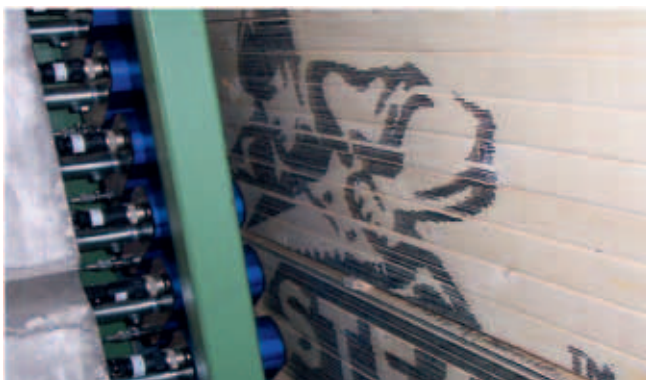
Großflächige Kennzeichnung von Bretterstapeln
