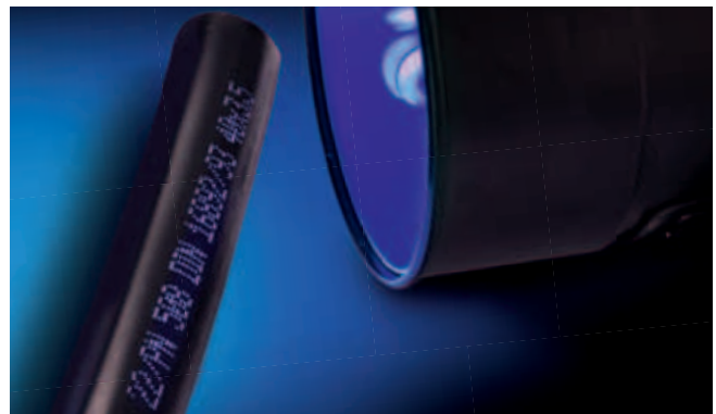
Kennzeichnung von Kunststoffteilen mit UV-Tinte
