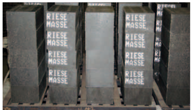
Feuerfeststeinmarkierung mit Hochtemperaturtinte
