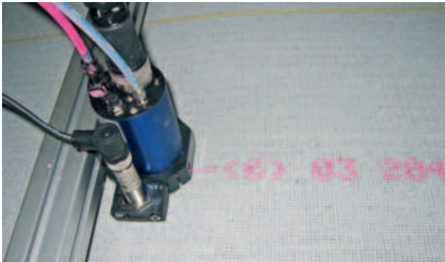
Teppichkennzeichnung mit Wassertinte
