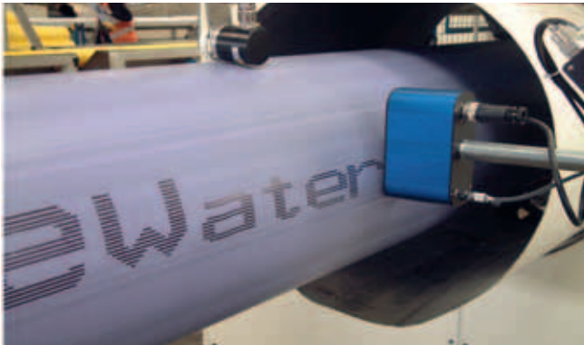
Codierung extrudierter PVC-Rohre
