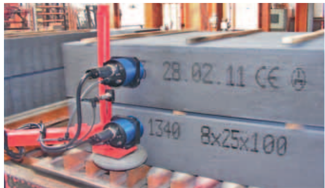
Codierung von Betonfertigteilen
