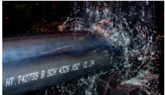
Stahlrohrkennzeichnung mit pigmentierter MEK-Tinte
