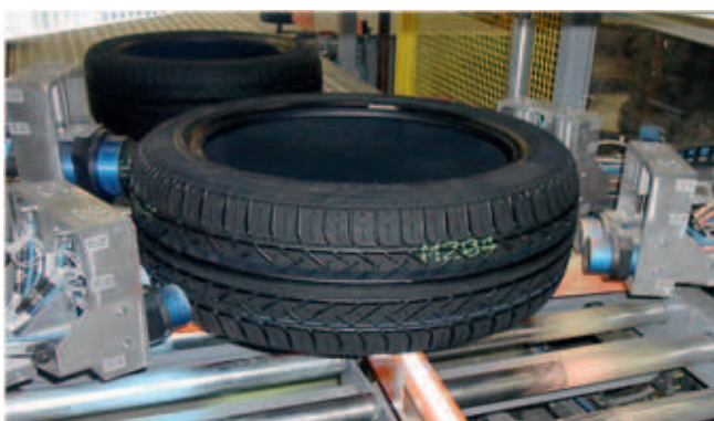
Farbstreifenmarkierung fertiger KFZ-Reifen
