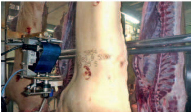
Codierung von Schweinehälften mit Lebensmitteltinte
