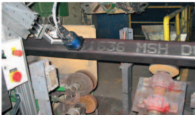
Kennzeichnung von Kantrohren
