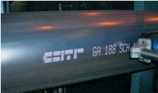
Beschriftung von Stahlrohren
