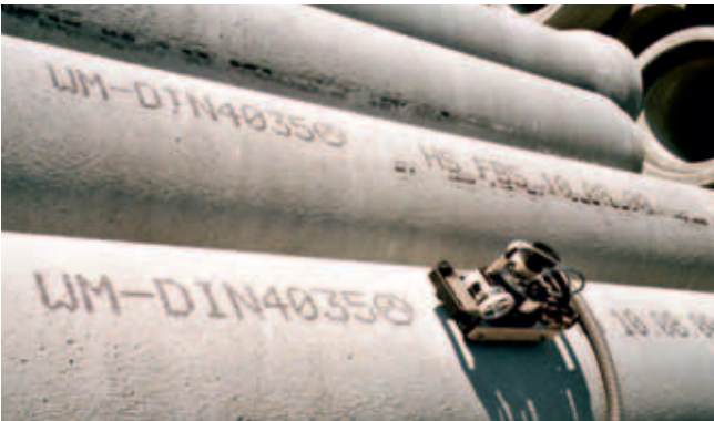
Mobile Beschriftung von Betonrohren
