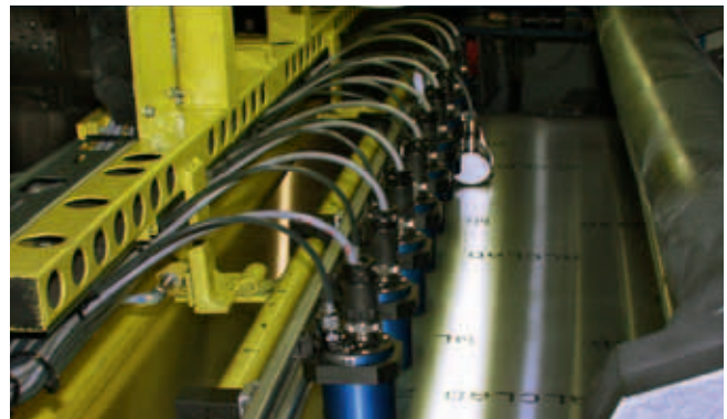
Codierung beölter Bleche mit Acetontinte
